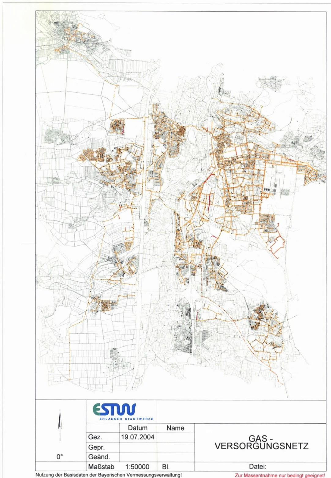
Abb. 49: Karte des Gasversorgungsnetzes Erlangen [36]
